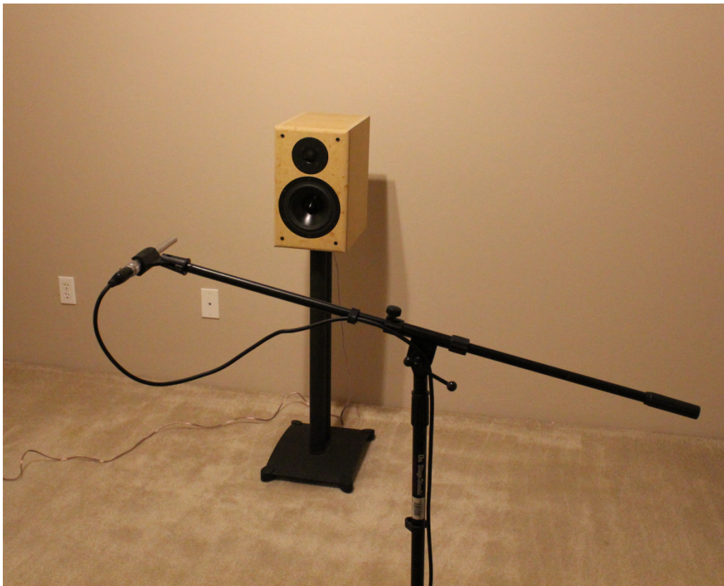
图 43: 待测扬声器以及与高音扬声器同轴并距离 1 米位置的校准的测量麦克风。
