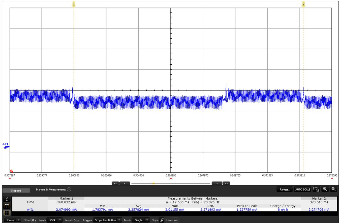
图 16. FIR 平均电流消耗与 Audio BoosterPack 和 Graphics LCD
