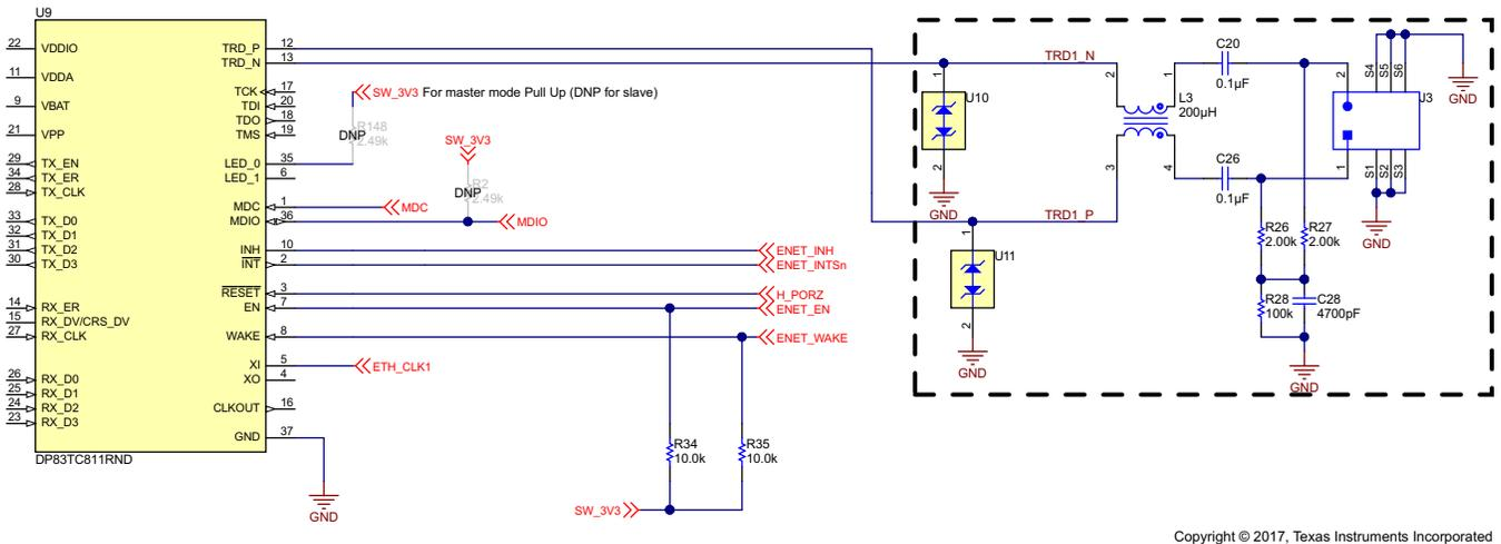
图 14. DP83TC811R-Q1 Connector Schematic
