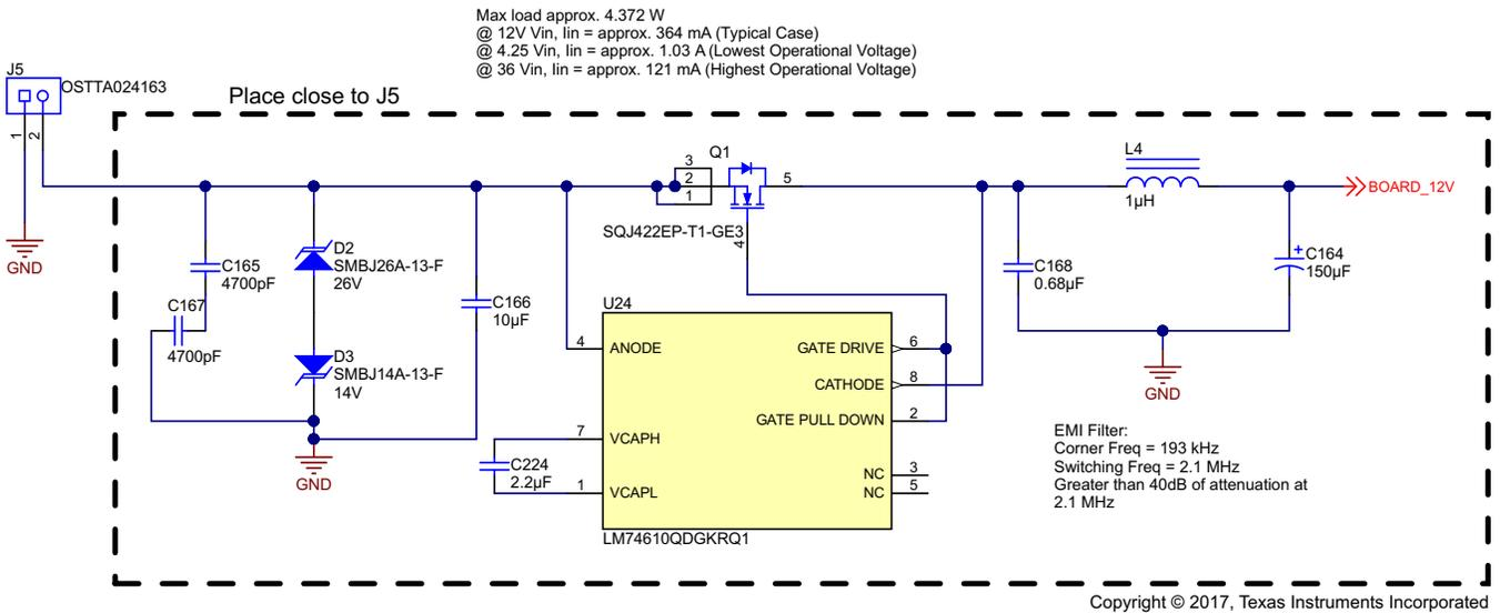
图 19. LM74610-Q1 Smart Diode Schematic
