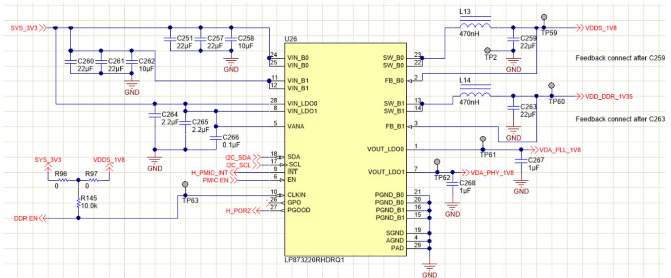
图 23. LP873220-Q1 Schematic
