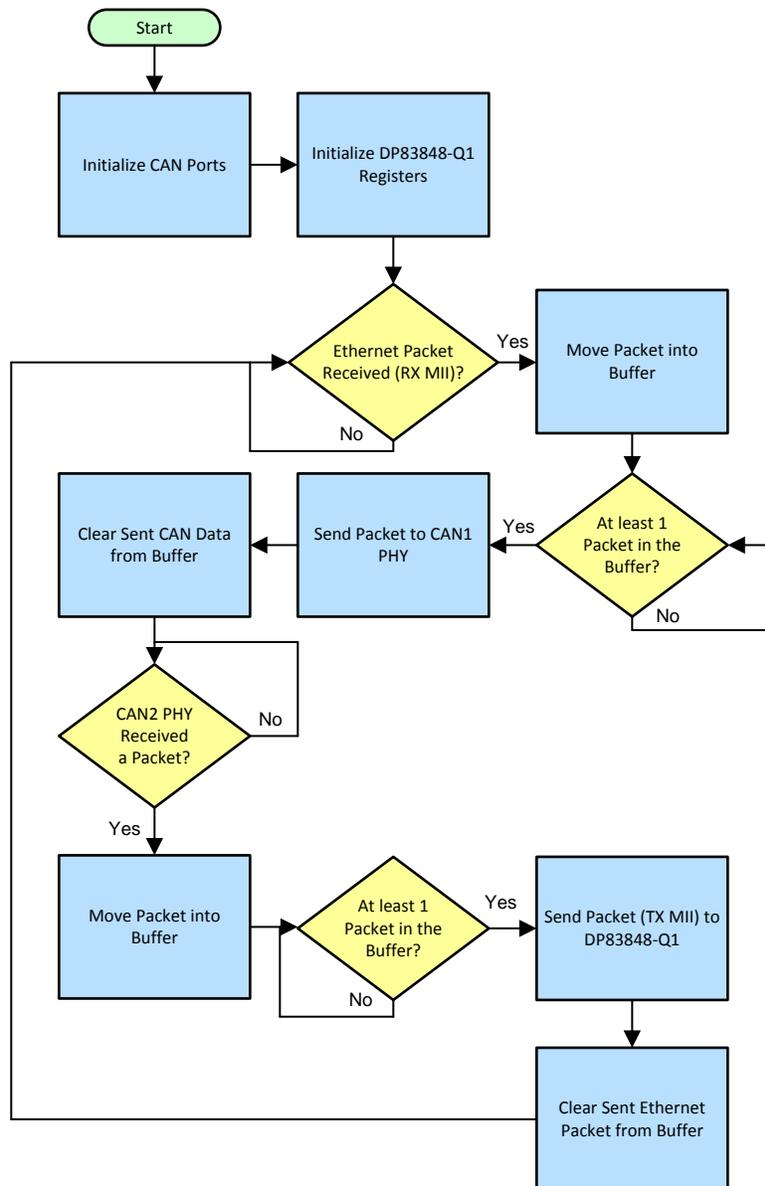
图 28. 100BASE-TX/CAN Loopback Flow Chart
