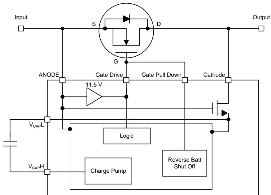
图 9. LM74610-Q1 Functional Block Diagram
