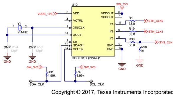
图 18. CDCE913-Q1 Clock Synthesizer Schematic
