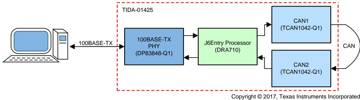
图 27. 100BASE-TX/CAN Loopback Block Diagram
