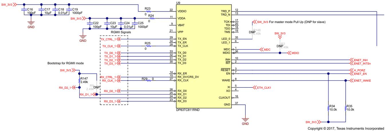
图 13. DP83TC811R-Q1 100BASE-T1 Ethernet PHY Schematic
