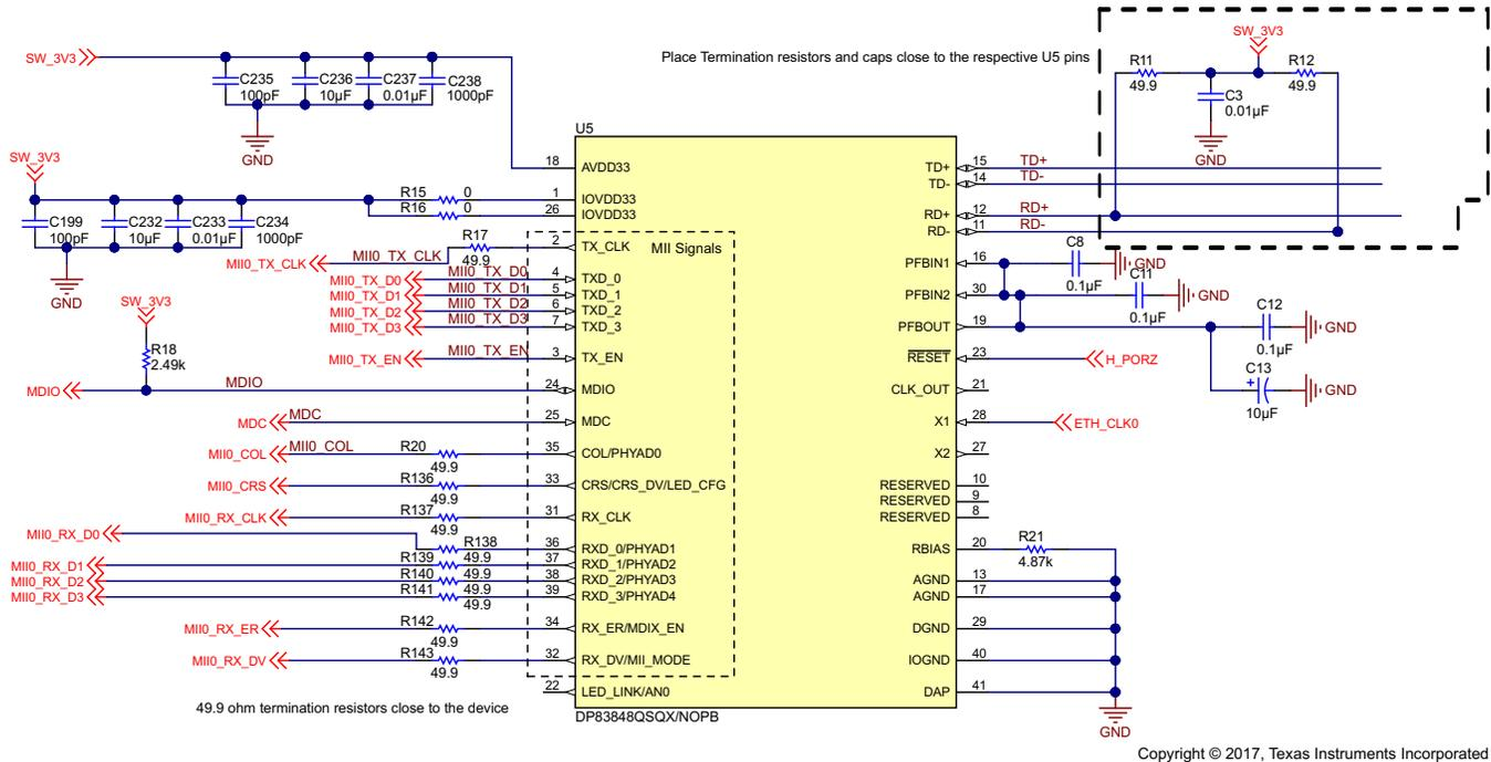
图 15. DP83848-Q1 100BASE-TX Ethernet PHY Schematic
