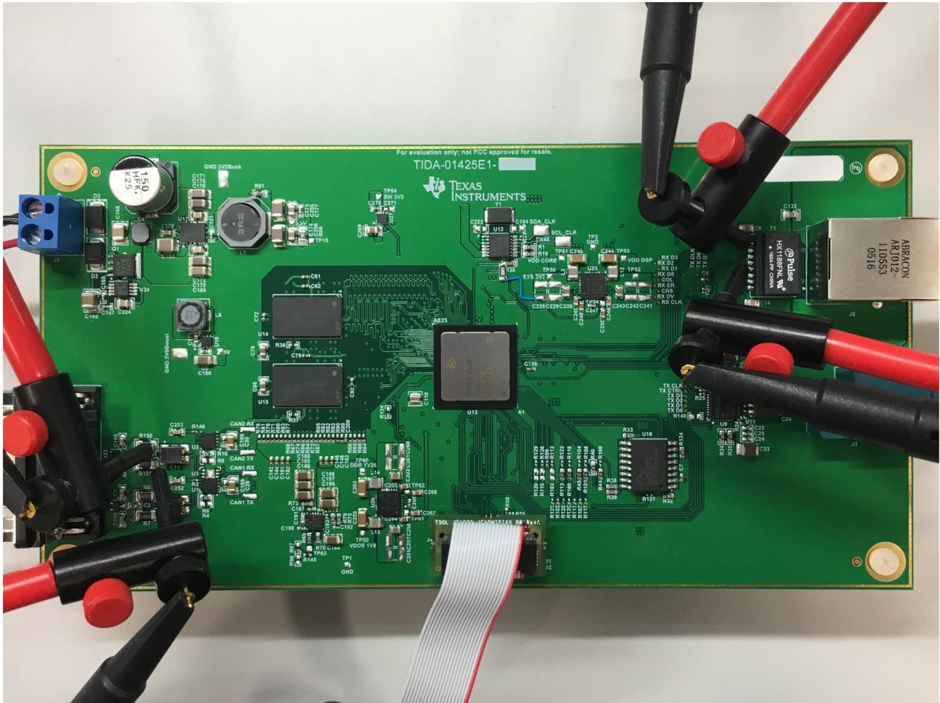
图 31. 100BASE-TX/CAN Loopback Probe Setup
