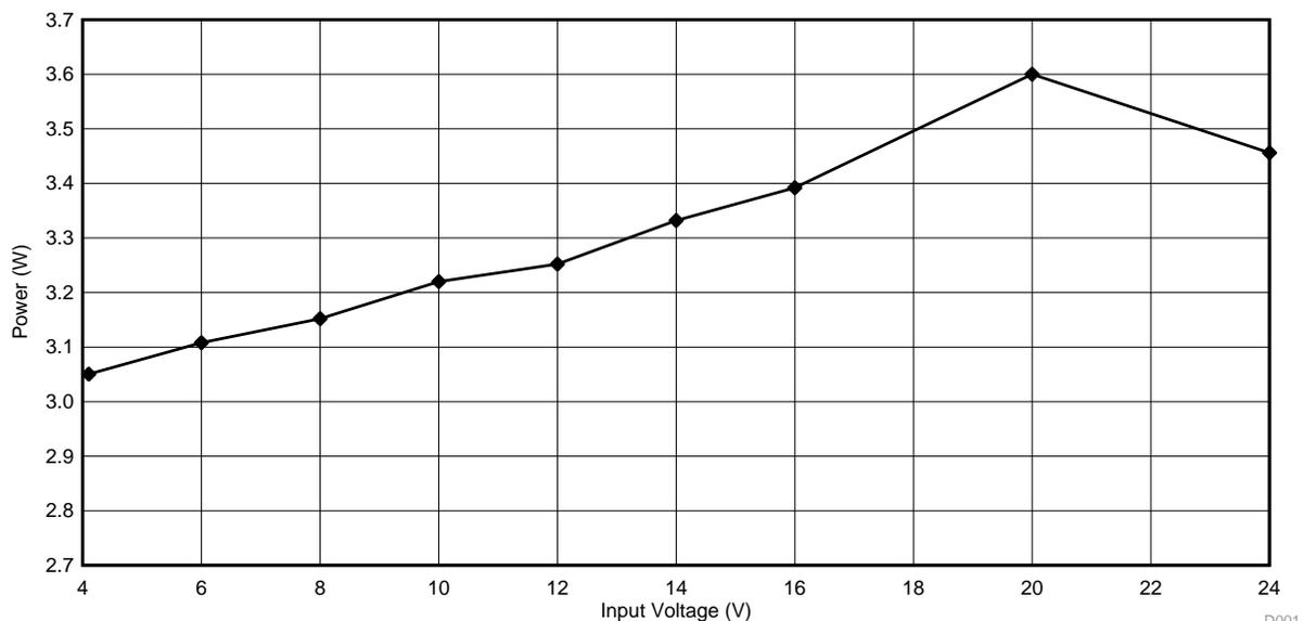
图 37. Power versus Input Voltage
