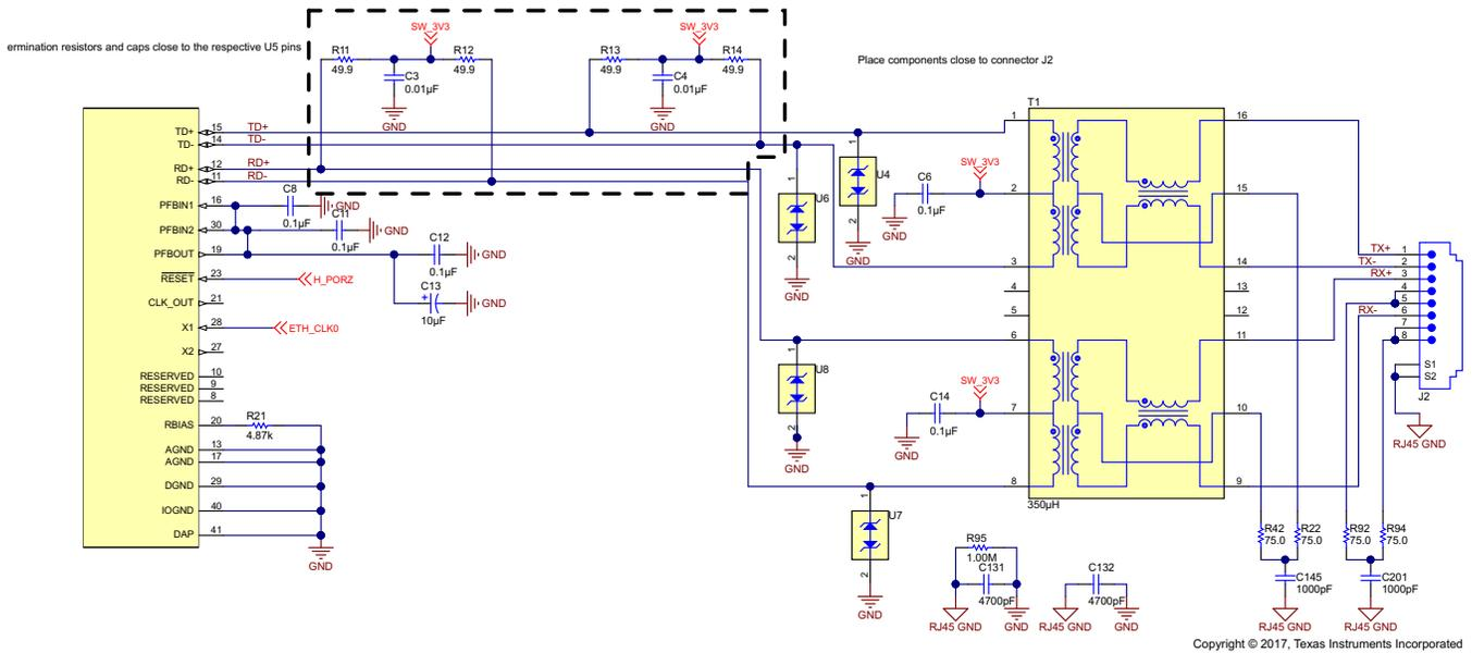
图 16. DP83848-Q1 Connector Schematic
