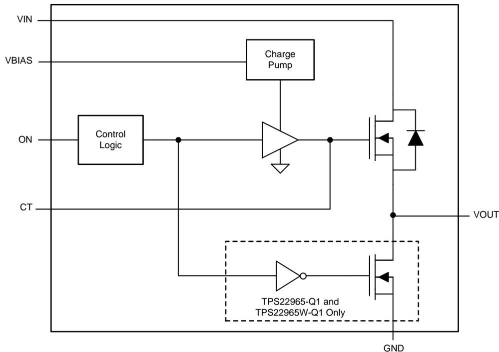
图 12. TPS22965-Q1 Functional Block Diagram
