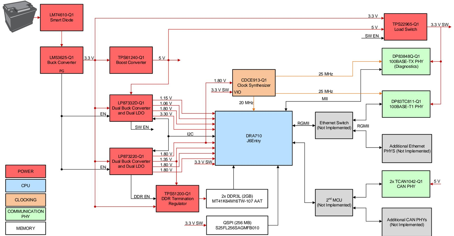
图 1. TIDA-01425 Block Diagram
