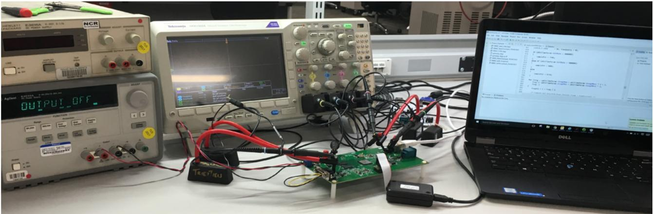
图 30. 100BASE-TX/CAN Loopback Test Setup
