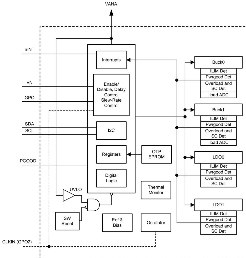
图 8. LP8732x-Q1 Block Diagram
