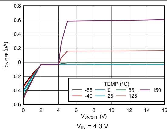
图 5-55. ON/ OFF Pin Current versus V<sub>ON/ OFF</sub> (New Chip)
