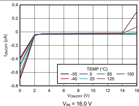
图 5-56. ON/ OFF Pin Current versus V<sub>ON/ OFF</sub> (New Chip)
