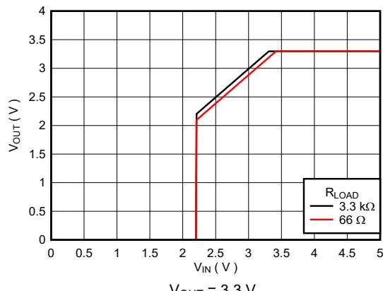
图 5-8. Output Voltage versus  $V_{IN}$  (New Chip)
