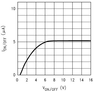
图 5-54. ON/ OFF Pin Current versus V<sub>ON/ OFF</sub> (Legacy Chip)
