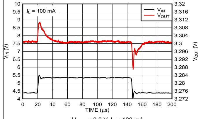
图 7-8. Line Transient Response (New Chip)
