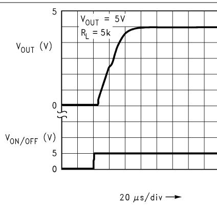
图 7-16. Turn-on Waveform (Legacy Chip)
