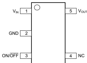
图 4-1. DBV Package, 5-Pin SOT-23 (Top View)
