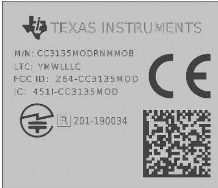
图 9-1. SimpleLink™ CC3135 Module Markings
