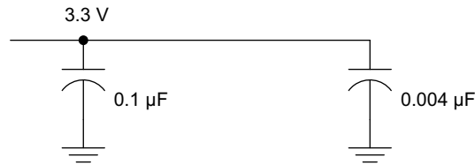
图 9-2. 建议的 M-LVDS 旁路电容器布局
